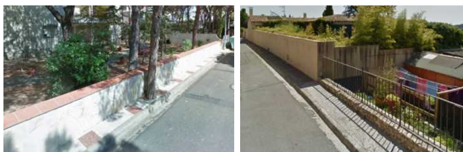
Figura 4.5.– Trams de carrer amb voreres inferiors a 0,9 metres: carrer de Maó (esquerra) i carrer Sicars (dreta).
