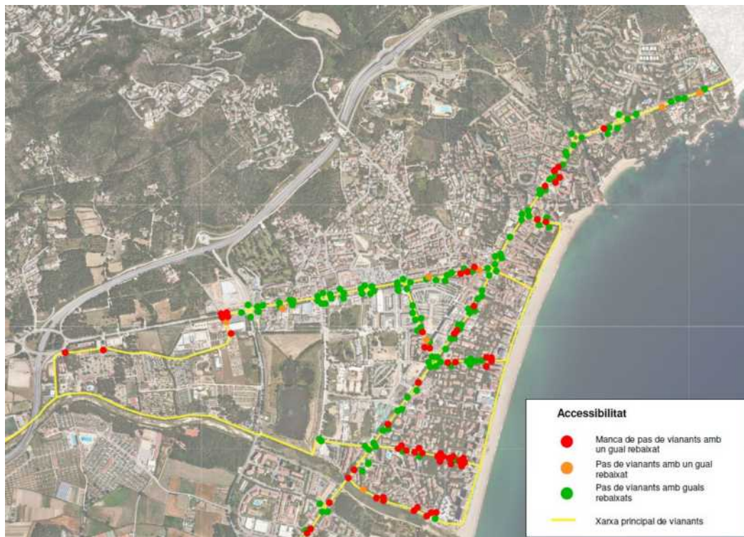
Figura 4.7. Passos de vianants a la xarxa principal de vianants del nucli de Platja d'Aro. Font: elaboració pròpia.
